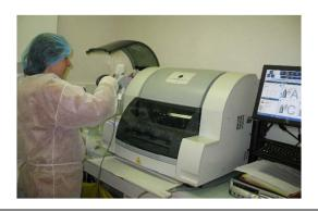
3 <u>Amplification par PCR en temps réel</u> **ABI7300**
